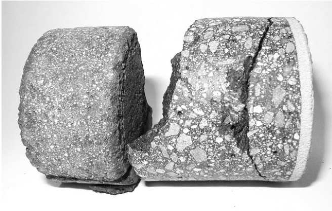
Bild 3. Bohrkern vom Arbeitsplatz der „Schwelmer Gruppe“; von rechts nach links: Teppichboden, Gussasphalt und Teer.
